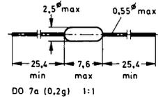
**Anwendung** Als Kapazitäts-Variations-Diode, besonders geeignet für automatische VHF-Abstimmung. Der Kapazitätsbereich bei  $U_R = 30$  V von 3,6 bis 6,8 pF wird in drei Gruppen aufgeteilt, die durch die Farbe des Katodenrings gekennzeichnet sind.
