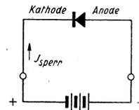
Die Germanium-Diode arbeitet in **Sperrichtung**, wenn die angelegte Spannung (**Sperrspannung**,  $U_{\text{sperr}}$ ) so angeschlossen ist, daß die Anode negatives und die Kathode positives Potential erhält. Der hierbei fließende Strom wird mit **Sperrstrom** ( $I_{\text{sperr}}$ ) bezeichnet.
