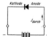
Die Germanium-Diode arbeitet in **Durchlaßrichtung**, wenn die angelegte Spannung (**Durchlaßspannung**,  $U_{\text{durch}}$ ) so angeschlossen ist, daß die Anode positives und die Kathode negatives Potential erhält. Der hierbei fließende Strom wird mit **Durchlaßstrom** ( $I_{\text{durch}}$ ) bezeichnet.
